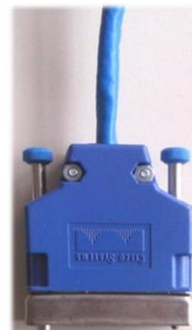
Imagen 6.55 “Vista superior del extremo V.35 hembra (DCE)”
