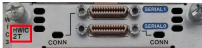
Imagen 6.64 “Identificación del modelo de tarjeta”
