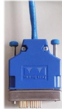
Imagen 6.57 “Vista superior del extremo V.35 macho (DTE)”
