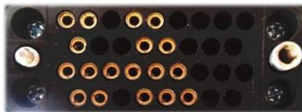
Imagen 6.54 “Vista frontal del extremo V.35 hembra (DCE)”
