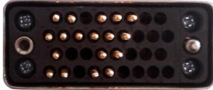
Imagen 6.56 “Vista frontal del extremo V.35 macho (DTE)”
